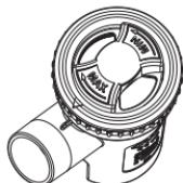
Um die Inhalationstherapie zu beschleunigen, drehen Sie den Geschwindigkeitsregler (B2.2.3) im Uhrzeigersinn.
