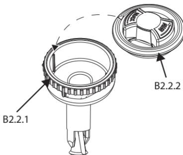
3. Giet het door de arts voorgeschreven geneesmiddel in het onderste gedeelte (B2.1). Plaats het bovenste deel (B2.2) in het onderste deel (B2.1), sluit de vernevelaar door het bovenste deel (B2.2) met de klok mee te draaien.
