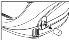
**Om het filter te vervangen, trekt u het uit zoals aangegeven in de figuur.**
