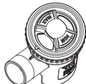
Per rendere più efficace la terapia inalatoria ruotate il selettori di velocità (B2.2.3) in senso antiorario, in questo caso otterrete un'acquisizione ottimale del farmaco riducendo al minimo la dispersione dello stesso nell'ambiente circostante.
