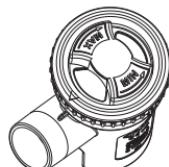
Pour rendre le traitement par inhalation plus efficace, tournez le sélecteur de vitesse (B2.2.3) dans le sens inverse des aiguilles d'une montre. Dans ce cas, vous obtiendrez une acquisition optimale du médicament tout en minimisant la dispersion du médicament dans l'environnement.
