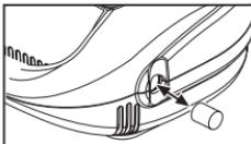
**Para sustituir el filtro, extráigalo como se muestra en la figura.**
