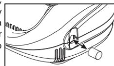
**Aby wymienić filtr, wyciągnij go w sposób pokazany na rysunku.**
