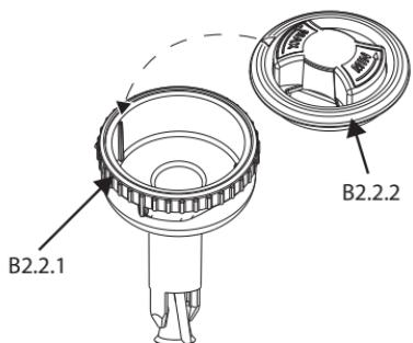
2. أعد تجميع الجزء العلوي مع مفتاح الاختيار على النحو المبين في مخطط التوصيل بالقسم B2.2. تنبئه، يجب أن يتم تعشيق مفتاح الاختيار (B2.2.2) (B2.2.2.1) مثلثاً في الجزء العلوي (B2.2.1)، لتغيير ذلك، يجب محاذاة السهم الموجود على دعامة مفتاح الاختيار مع ذكر وصلة الملحقات، انظر الصورة.
