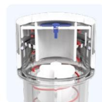
In posizione di riposo, la molla spinge il cappuccio della valvola evitando il passaggio dell'aria.
